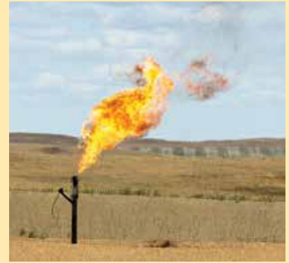
Methane gas flare.
